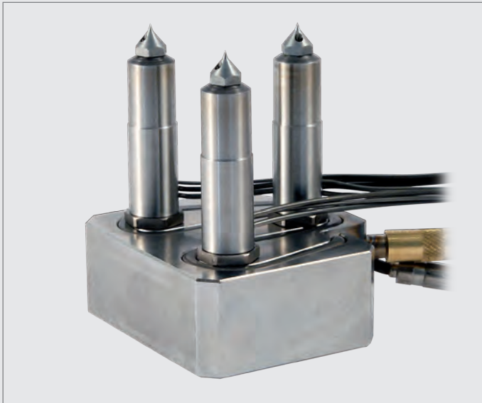
Komplette Heiße Seite für eine Boy Spritzgießmaschine in 3-fach Konfiguration (linke Seite) und der dazugehörige vollbalancierte Verteiler mit eingeschraubten Heißkanaldüsen (oben links). Die neuentwickelten Düsen sind vollständig aus Edelstahl gefertigt. Deutlich zu erkennen ist die Dichtfläche im hinteren Teil der Düse (oben rechts).
