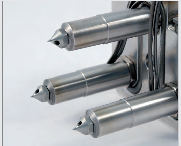
Komplette Heiße Seite für eine Boy Spritzgießmaschine in 3-fach Konfiguration (linke Seite) und der dazugehörige vollbalancierte Verteiler mit eingeschraubten Heißkanaldüsen (oben links). Die neuentwickelten Düsen sind vollständig aus Edelstahl gefertigt. Deutlich zu erkennen ist die Dichtfläche im hinteren Teil der Düse (oben rechts).
